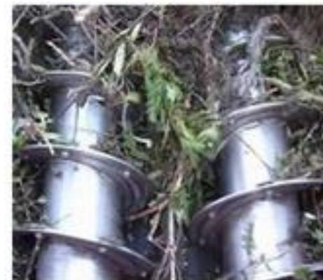
Vis sans fin de broyeur à vis
